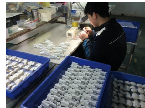
Jedes Resinteil wird von Hand gesäubert und fein geschliffen.
