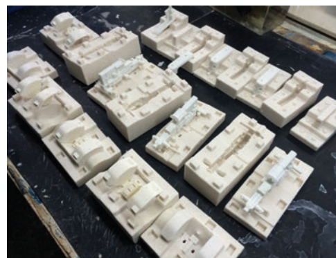
Viel Zeit braucht es beim Casting der Formenteile. Hier ist sauberes und exaktes Arbeiten von höchster Wichtigkeit.
