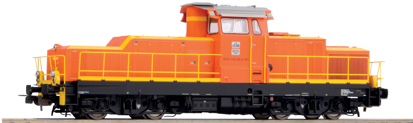
Locomotiva diesel D.145.2006 di primo lotto FS, 98 83 2145 206-8 I-RFI OMR MESSINA con ripetitori di segnali, Epoca VI
