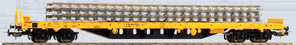
24501 Carro pianale Rs Ep. VI, carico di una pila di traversine in calcestruzzo
